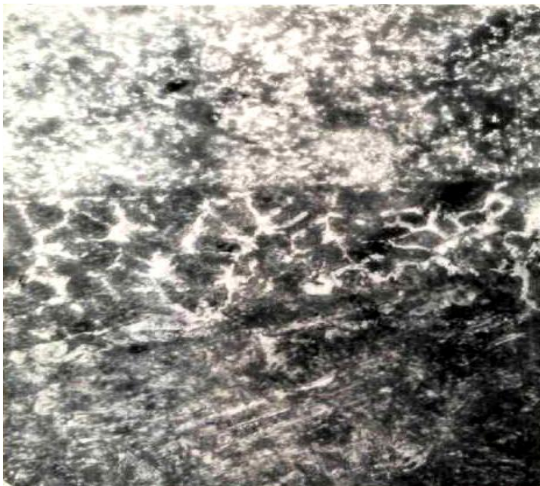
9.3-rasm. Molibden asosidagi qotishma MoTiC-po'lat stal 40X kompozitsiyasi termik ishlov berilgandan keyingi mikrostrukturasi. O'tish qatlami materiali Su-Ni asosidagi sim. x100 kattalashtirilgan
